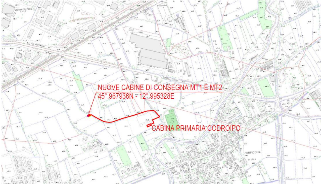
Figura 34: Percorso dell'elettrodotto MT su CTR
